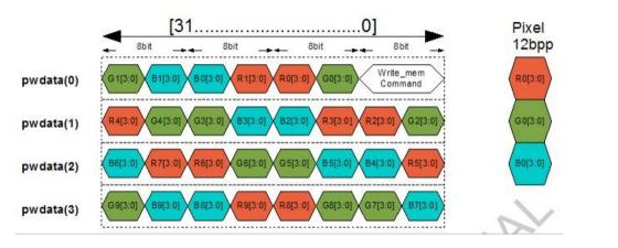
Fig. 37-5 12 bpp APB Pixel to Byte Organization
